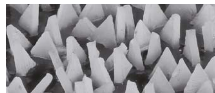
Orientación óptima del grano abrasivo VICTOGRAIN
