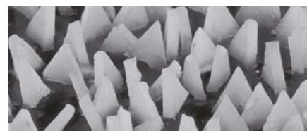
Orientación óptima del grano abrasivo VICTOGRAIN
