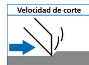
La velocidad de corte es la distancia que recorre el filo de la herramienta en la dirección del movimiento principal sobre el material a mecanizar.
